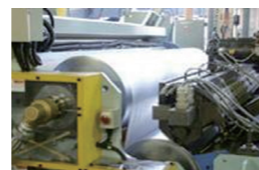
各種プラスチックフィルムやシート類を製造する装置※セパレータフィルム用
