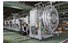
プラスチックのベース材料（ペレット）を製造する装置
